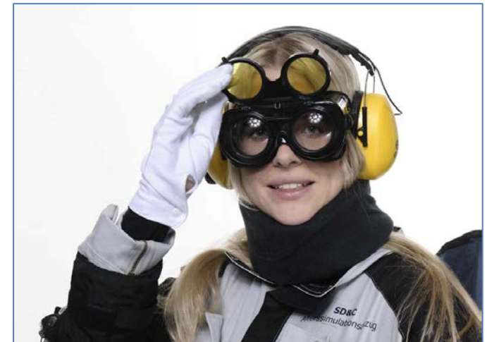
Abbildung 3: Die zweistufige 5-Faktoren-Simulationsbrille vom Profi-Modell 2011 simuliert beim Beta wahlweise 20 oder 40 Jahre Alterung.
